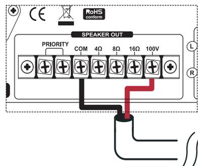
Lorsque vous raccordez vos haut-parleurs à l'amplificateur prenez garde de respecter les polarités. **Raccordez** les haut-parleurs équipés de transformateurs aux bornes **COM** et **100V** de l'amplificateur.
