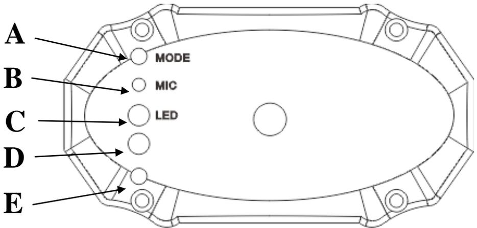
**【A】** MODE: Interrupteur à clé 4 positions, change le mode de travail, chaque position à un mode de fonctionnement. (Sound-Auto1-Auto2)
