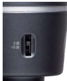
Figura 1: Comutador de seleção para a pré-atenuação
