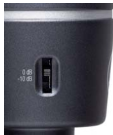
Figura 1: Selettore per la preattenuazione
