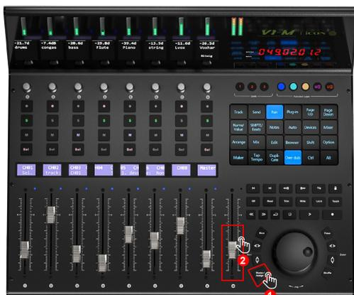
È inoltre possibile assegnare valori CC, Note, pitchbend e canali MIDI al fader master in modalità Assegna tramite iMAP.
