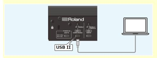
Se un'alimentazione di 5 V/3 A non può essere fornita a questa unità, collegate un trasformatore di CA (5 V/3 A o 9 V/3 A) che supporta USB PD alla porta POWER IN.
