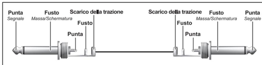
Fig. 5.1: presa mono jack 6,3-mm
