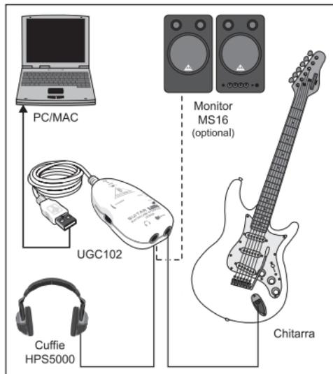
Fig. 4.1: Cablaggio della UCG102
