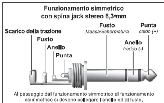
*Fig. 5.2: stereo jack 6,3-mm*
