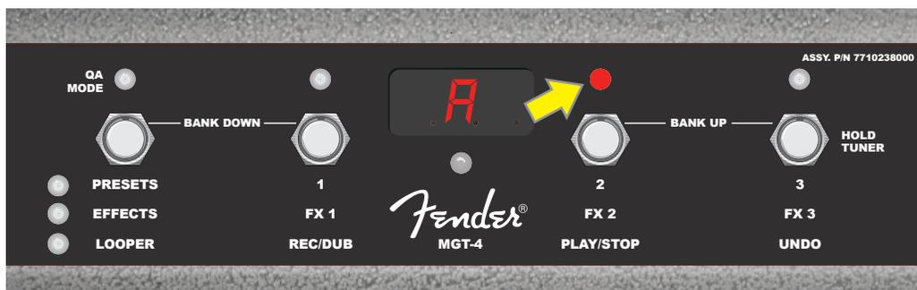
Nell'esempio illustrato di seguito, è visualizzata una nota di "A" con una accordatura leggermente verso l'alto, che è indicata con il diodo LED rosso della FUNZIONE nella parte in alto a destra presso il centro (indicato con una freccia gialla).
