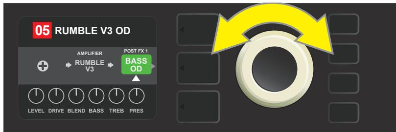
*Il nuovo effetto aggiunto, evidenziato e indicato con la freccia bianca sotto e una descrizione sopra l'effetto, sarà visualizzato in un campo di colore verde, indicando la possibilità di lasciare l'effetto nella posizione data o di essere spostato ad un'altra posizione nel percorso del segnale ruotando ENCODER.*
