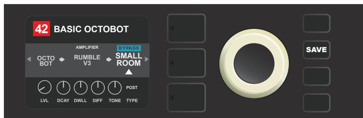
Dopo la selezione di bypassare l'effetto (nella figura indicato con la freccia bianca sotto e con la descrizione nel campo blu di "BYPASS" sopra l'effetto), si potrà continuare nelle modifiche di altri parametri oppure si possono mantenere le modifiche premendo il pulsante di funzione retroilluminato SAVE.
