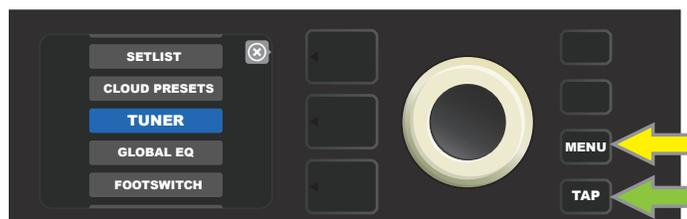
Per entrare nella funzione dell'accordatore è sufficiente premere il pulsante della funzione MENU (indicato con una freccia gialla), in seguito vi troverete nel menu delle opzioni contenente anche l'opzione dell'accordatore oppure premendo e tenendo premuto il tasto della funzione TAP (indicato con una freccia verde).
