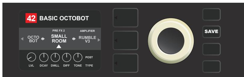
Dopo avere spostato l'effetto in una nuova posizione (nella figura indicato con la freccia bianca sotto e con la descrizione sopra l'effetto), si potrà continuare nelle modifiche di altri parametri oppure sarà possibile mantenere le modifiche premendo il pulsante di funzione retroilluminato SAVE.
