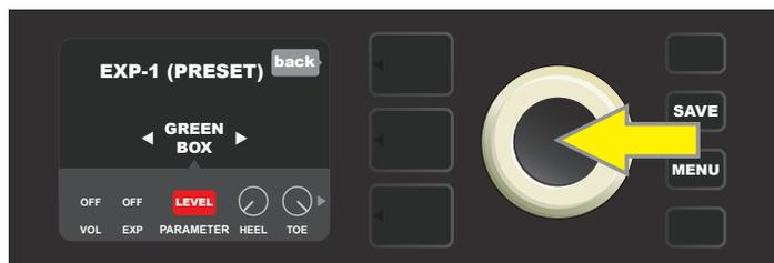
Nell'esempio riportato sopra, premere ENCODER (indicato con la freccia gialla) nell'opzione "LEVEL". Il colore del campo di questa opzione cambierà da blu a rosso, così sarà indicato, che si può modificare l'impostazione di questo parametro dell'effetto Green Box overdrive per il controllo con il pedale EXP-1.
