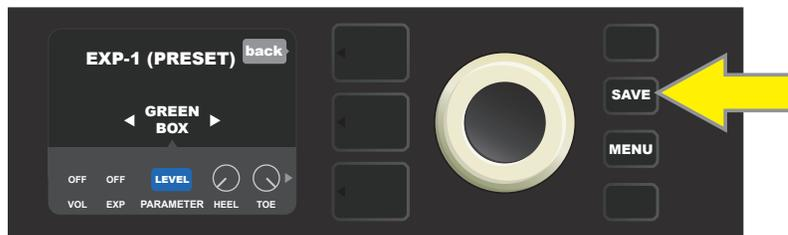
Nel LIVELLO DEI CONTROLLI si trovano alcune altre modalità del comando del pedale EXP-1. Tramite ENCODER, scorrere tra queste modalità e selezionare le singole modalità nelle quali sono contenute le possibilità. Sono le modalità:
