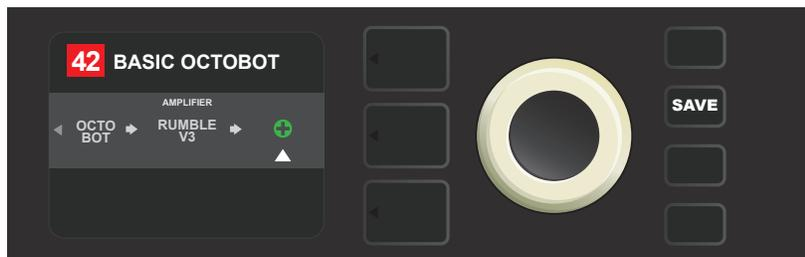
Il LIVELLO DEL PERCORSO DEL SEGNALE mostrerà l'informazione che l'effetto è stato eliminato (freccia bianca) con la visualizzazione del segno del simbolo (+) (come è visibile nella figura), oppure spostando un altro effetto (se presente) nella posizione dell'effetto eliminato.
