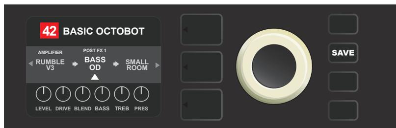
Con l'effetto nella nuova posizione (nella figura indicato con la freccia bianca sotto e con la descrizione sopra l'effetto), si potrà continuare nelle modifiche di altri parametri oppure sarà possibile mantenere le modifiche premendo il pulsante di funzione retroilluminato SAVE.
