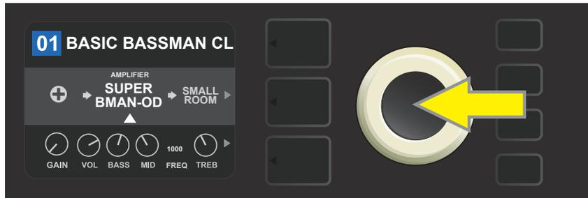
Per cambiare il modello dell'amplificatore evidenziato nel preferito nel LIVELLO DEL PERCORSO DEL SEGNALE (come indicato nella figura con la freccia bianca in basso e l'etichetta dell'"amplificatore" sopra ad essa) con un modello di amplificatore diverso, premere prima ENCODER per accedere al menu di altri modelli di amplificatori.
