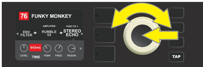
*Il tempo degli effetti del riverbero e della modulazione si possono cambiare anche evidenziando i valori numerici dei parametri di tempo al LIVELLO DEI CONTROLLI, premere e ruotare ENCODER, in modo da impostare il tempo richiesto.*
