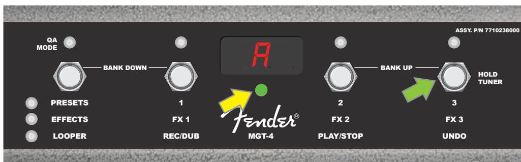
Nell'esempio illustrato di seguito, è visualizzata una nota di "A" con una accordatura esatta, che è indicata con il diodo LED verde della FUNZIONE nella parte al centro sotto la FINESTRA DEL DISPLAY (indicato con una freccia gialla). Dopo avere terminato la procedura per l'accordatura, premere il tasto di FUNZIONE 3 (indicato con una freccia verde), ed in questo modo si uscirà dalla funzione di accordatura tramite il pedale a comando.
