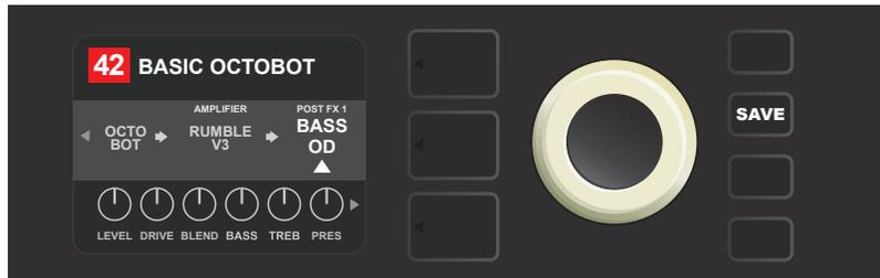
Dopo la selezione della sostituzione dell'effetto (nella figura indicato con la freccia bianca sotto e con la descrizione sopra l'effetto), si potrà continuare nelle modifiche di altri parametri oppure sarà possibile mantenere le modifiche premendo il pulsante di funzione retroilluminato SAVE.
